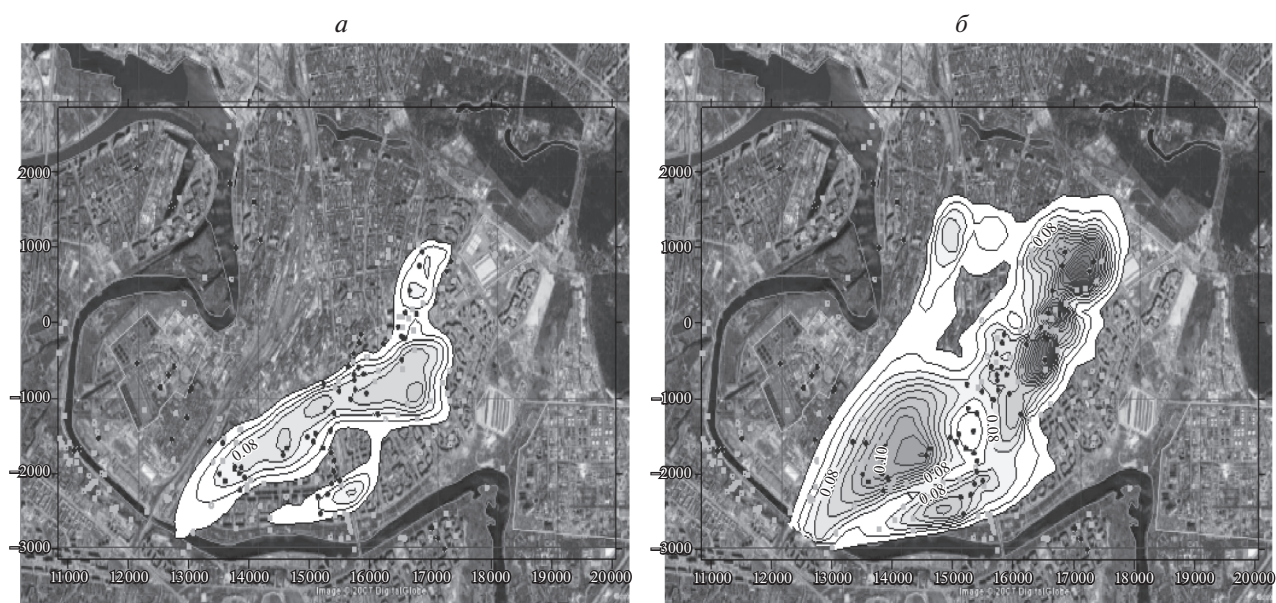
Рис. 9. Распределение концентраций в эксплуатируемом водоносном горизонте. Модель: а — без гидрогеологических окон, б — с гидрогеологическими окнами (осредненные по 50-ти вариантам концентрации).
