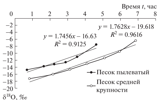
Рис. 4. Линейная зависимость значений \delta^{18}\text{O} в порции конденсата испарившейся воды из песков от времени ( t ) при температуре T = 180^\circ\text{C} .
