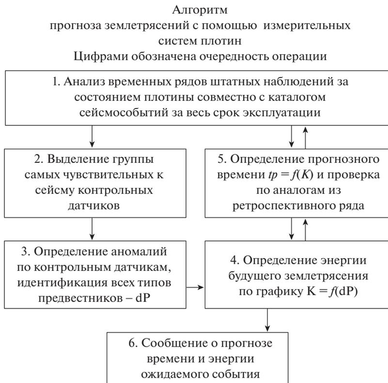
**Рис. 6.** Алгоритм краткосрочного прогноза землетрясений с помощью измерительных систем плотин. Цифрами обозначена очередность операций.
