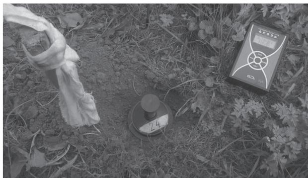
**Рис. 4.** Накопительная камера НК-32 для измерения плотности потока радона, установленная в подготовленную лунку.
