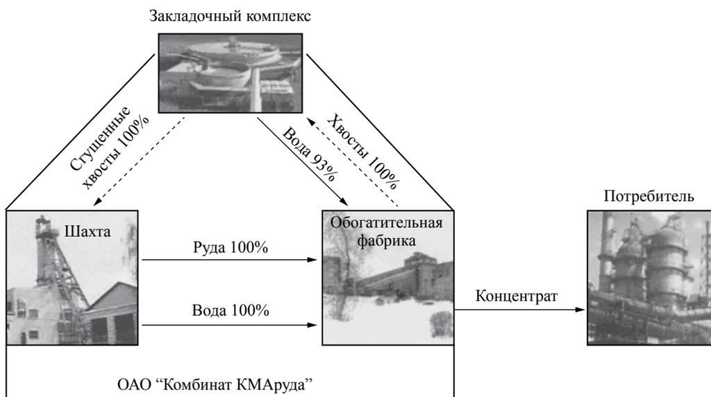
Рис. 3. Технологическая схема движения минерально-сырьевых потоков.
