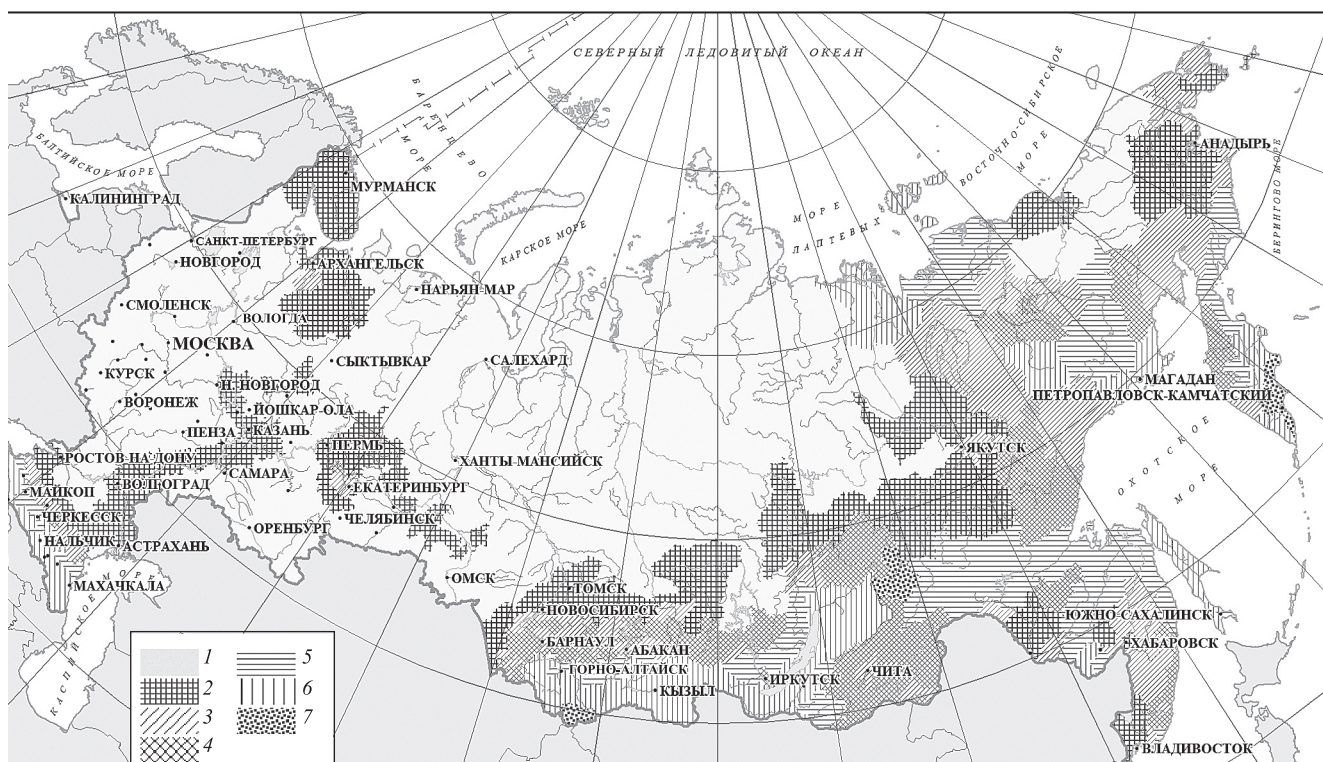
Рис. 2. Карта индивидуального сейсмического риска R_2 [ 10^{-5} год ^{-1} ] для населения Российской Федерации; значения риска по административным районам: 1 – менее 0.1, 2 – 0.1-1, 3 – 1-5, 4 – 5-10, 5 – 10-30, 6 – 30-100, 7 – более 100.
