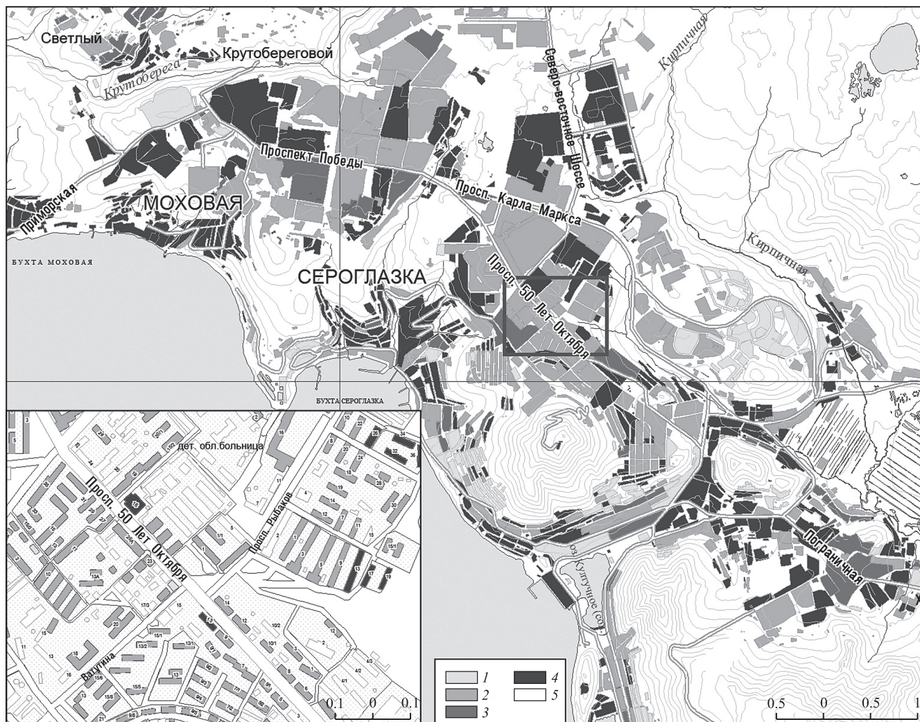
Рис. 7. Фрагмент карты индивидуального сейсмического риска R_{i1} [ 10^{-5} год ^{-1} ] для населения г. Петропавловска-Камчатского, построенной с использованием карты СМР территории города; 1 – менее 1; 2 – 1-5; 3 – 5-10; 4 – более 10; 5 – расчеты не проводились.
