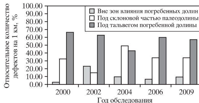
Рис. 5. Количество выявленных течей в перегонных тоннелях “Черная речка – Пионерская” в зависимости от их расположения относительно элементов погребенных долин (по данным: 2000–2006 гг. – ТОИС ГУП “Петербургский метрополитен”, 2009 г. – СПГТИ (ТУ)).
