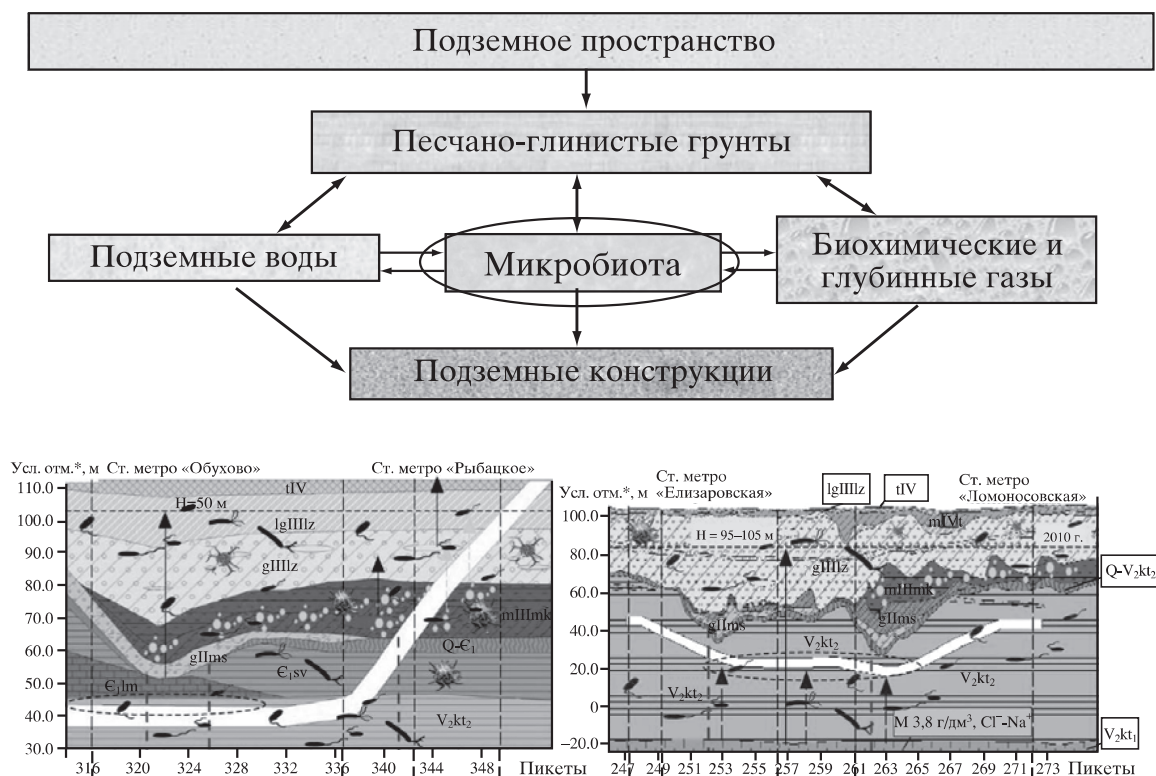
Рис. 1. Подземное пространство Санкт-Петербурга как многокомпонентная система и разрезы по трассе перегонных тоннелей метрополитена.
