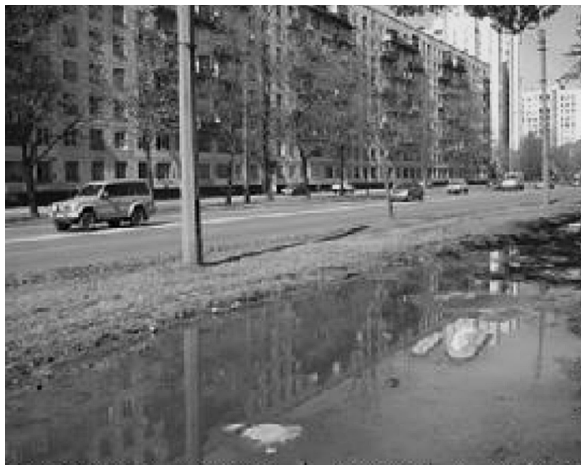
Рис. 3. Затопление территории в районе ул. Ключевой за счет восходящего перетекания вод полостровского горизонта (фото В.П. Вершинина).
