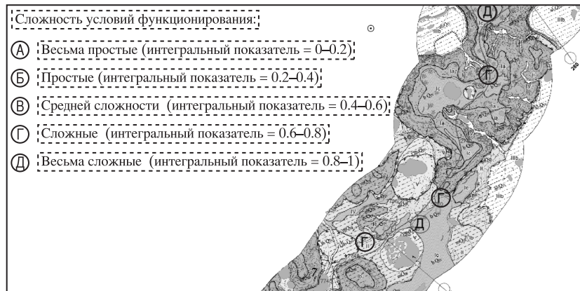
Рис. 3. Схематическое районирование участка железной дороги по сложности условий функционирования.
