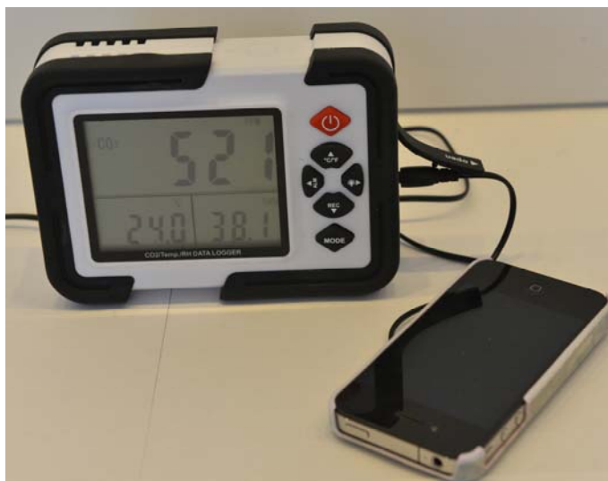
Рис. 1. Использованный для измерений регистратор концентрации \text{CO}_2 , влажности и температуры производства фирмы Perfect Prime. Для масштаба приложен iPhone 4
