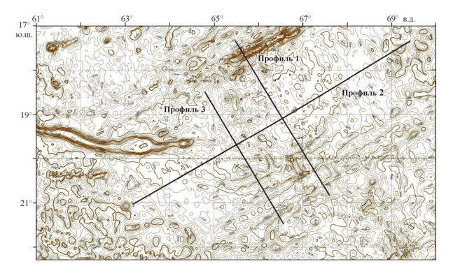
**Рис. 2.** Батиметрическая карта блока Родригес и местоположение профилей исследования При построении карты использовался массив данных SRTM 30 v.4. Изобаты даны через 200 м
