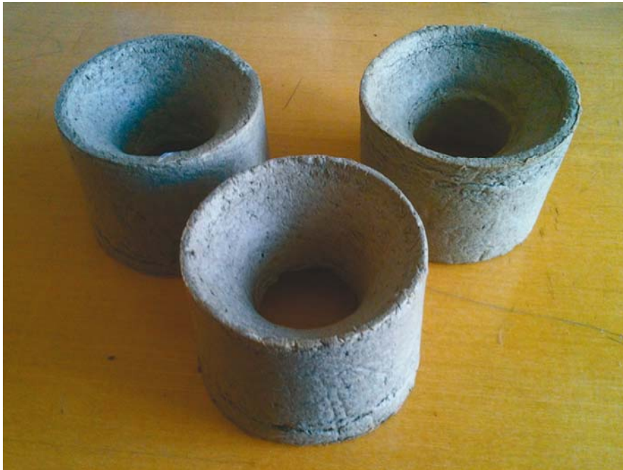
Рис. 5. Соединительные муфты НКТ, выполненные из базальтовых волокон
