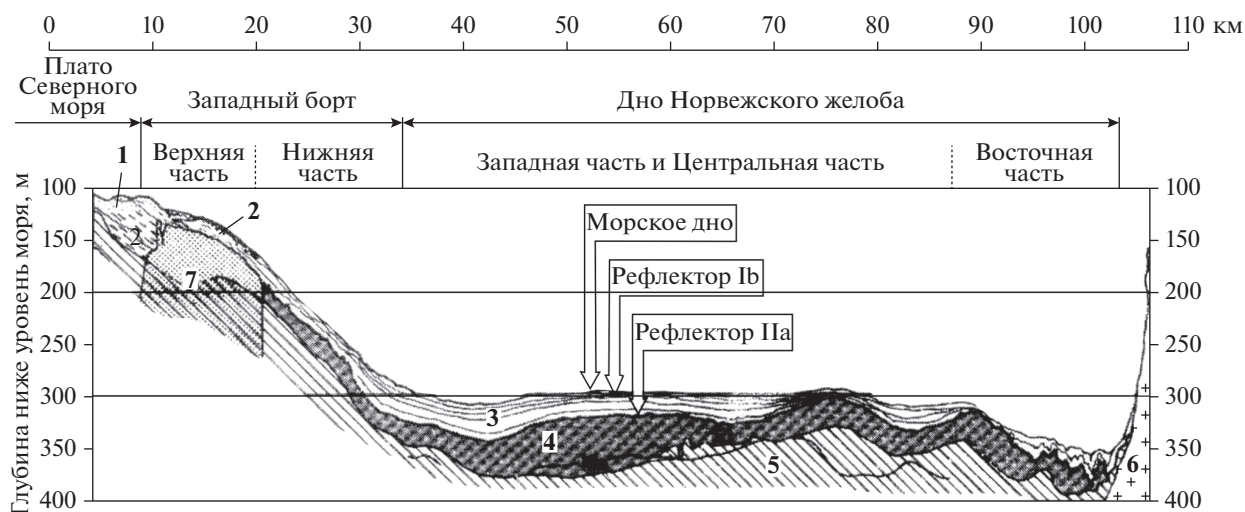
Рис. 5. Генерализованный опорный сейсмогеологический разрез четвертичных отложений Норвежского желоба и его бортов (по данным [15], с изменениями и дополнениями). Показано: 1 – песок; 2 – алевроит; 3 – мягкая ленточно-слоистая глина; 4 – бесструктурная песчано-алевритовая глина с рассеянным грубообломочным материалом; 5 – переуплотненная песчано-алевритовая глина с грубообломочным материалом; 6 – породы кристаллического основания; 7 – зона отсутствия полезной сейсмосаписи.
