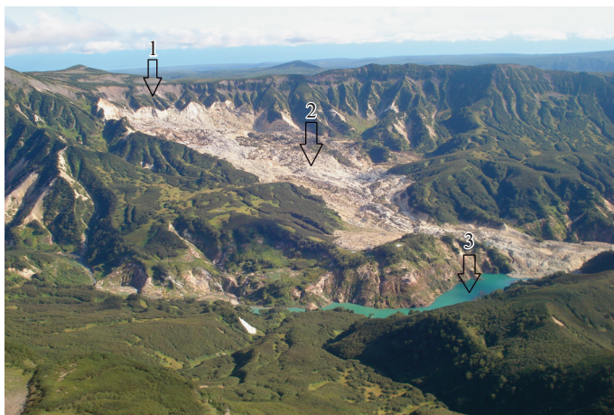
Рис. 3. Стенка срыва (1), тело оползня (2) и подпрудное озеро (3), образовавшееся после событий 3 июня 2007 г. (фото А. Завадской, 2008 г.).
