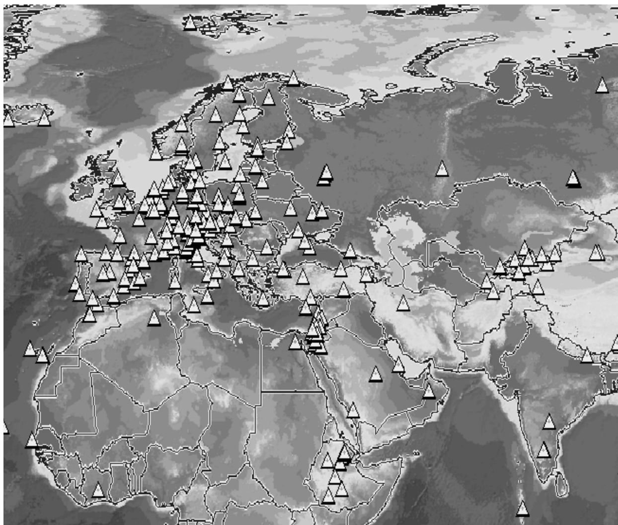
Рис. 3. Пример расположения наземных станций системы IGS для региона, охватываемого региональной моделью ионосферы: Европа, Африка и Европейская часть России.
