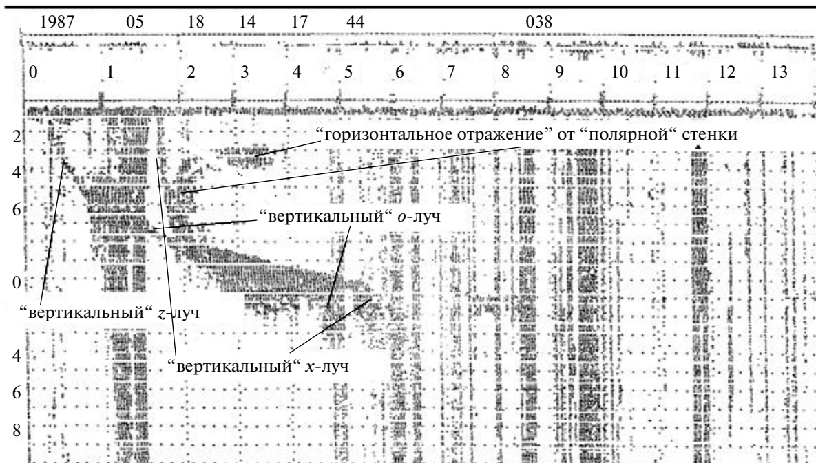
Рис. 2. Типичная для северных широт ионограмма внешнего зондирования ионосферы, имеющая необычный след, который интерпретирован как след отражения от слегка наклонной стенки повышенной электронной концентрации на фоне обычного вертикального N(h) -профиля.
