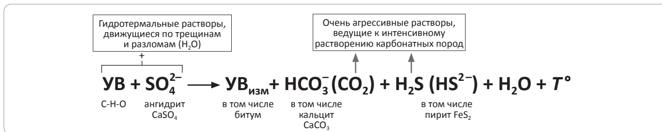
Рис. 8. Схематическое представление реакции абиогенной сульфатредукции Fig. 8. Schematic representation of the reaction of abiogenic sulfate reduction
