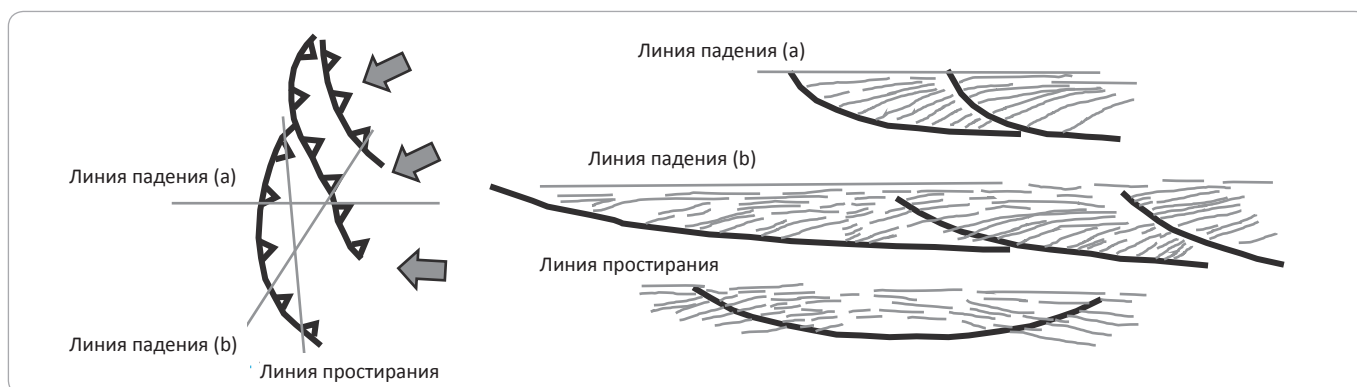
Рис. 5. Надвиговые деформации на временном сейсмическом профиле по линии падения (тангенциальное сжатие справа) Fig. 5. Thrust deformations on time seismic profile on dip line (tangential compression from the right)
