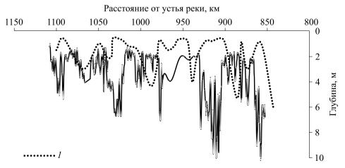
*Рис. 1.* Продольный профиль дна р. Оки от Калуги до Коломны к 2010–2012 гг. (глубина приведена к одному уровню, соответствующему расходу 150 м<sup>3</sup>/с в Калуге).
