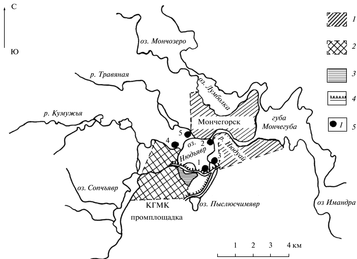
Рис. 1. Карта-схема расположения медно-никелевого комплекса. 1 – территория г. Мончегорск; 2 – промплощадка КГМК; 3 – отстойник технологических стоков КГМК – южная часть оз. Нудъявр; 4 – дамбы; 5 – наблюдательные створы на водных объектах: 1 – выпуск 1 – сброс воды из южной части озера, 2 – выпуск 2 – исток р. Нюдауй, 3 – р. Пыслычимъявр (Чимъявр), 4 – р. Кумужья, 5 – р. Травяная.
