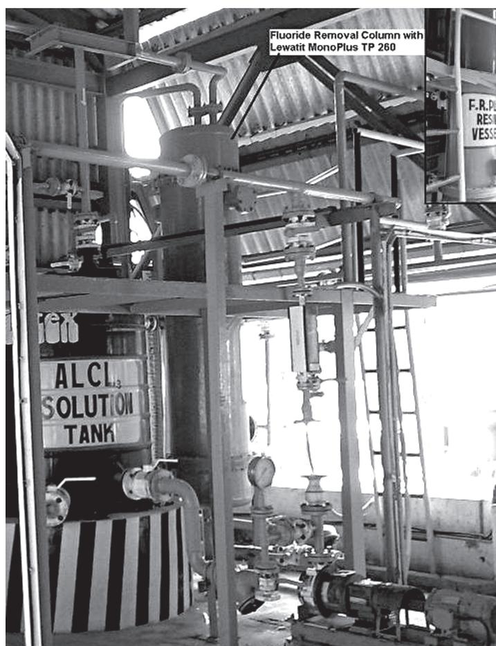
Рис. 4. Фторид-селективный ионообменник, действующий на крупнейшем химическом заводе в штате Гуджарат, Индия.
