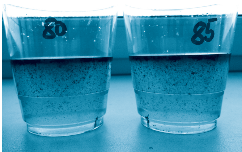
Рис. 2. Очистка стоков композицией реагентов Аква-Аурат 30+флокулянт Zetag 8180 и 8185.
