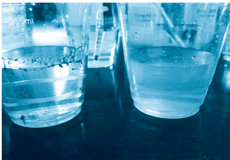
Рис. 1. Очистка стоков ЭЛОУ (слева) при отдельном введении неорганического коагулянта и флокулянта (справа) при одновременном введении реагентов.
