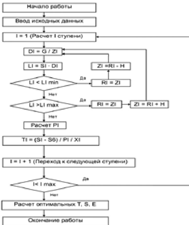
**Рис. 2.** Блок-схема алгоритма оптимизации процесса очистки сточных вод.
