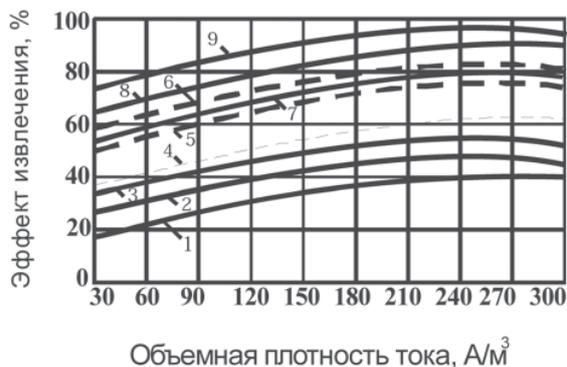
**Рис. 3.** Влияние объемной плотности тока на эффект извлечения бензинов марок АИ-93 (1,4,7), АИ-95 (2,5,8) и дизтоплива (3,6,9) при электрокоагуляции ионами железа дозой 50 мг/л и продолжительности электрофлотации, мин: 1,2,3-2; 4,5,6-5; 7,8,9-12
