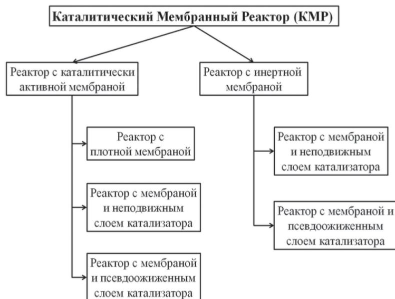
**Рис. 1.** Различные варианты конструкции мембранных реакторов.
