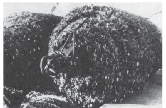
Рис. 7. Обрастание видами Lepadidae буев, экспонированных 21 сут. Восточно-экваториальный район Атлантического океана [по 8].
