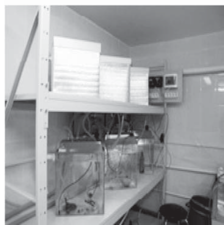
Рис. 1. Внешний вид (слева) и принципиальная схема (справа) аквариумной установки для адаптации гидробионтов. Условные обозначения: 1 – аквариум; 2 – змеевик стеклянный; 3 – электромагнитный клапан; 4 – регулятор напряжения; 5 – двухканальный регулятор температуры; 6 – лампа освещения; 7 – термопара.
