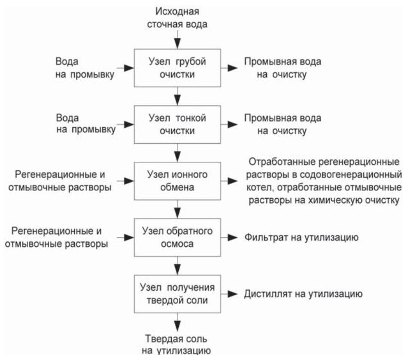
Рис. 1. Принципиальная схема очистки сточных вод на основе метода обратного осмоса.
