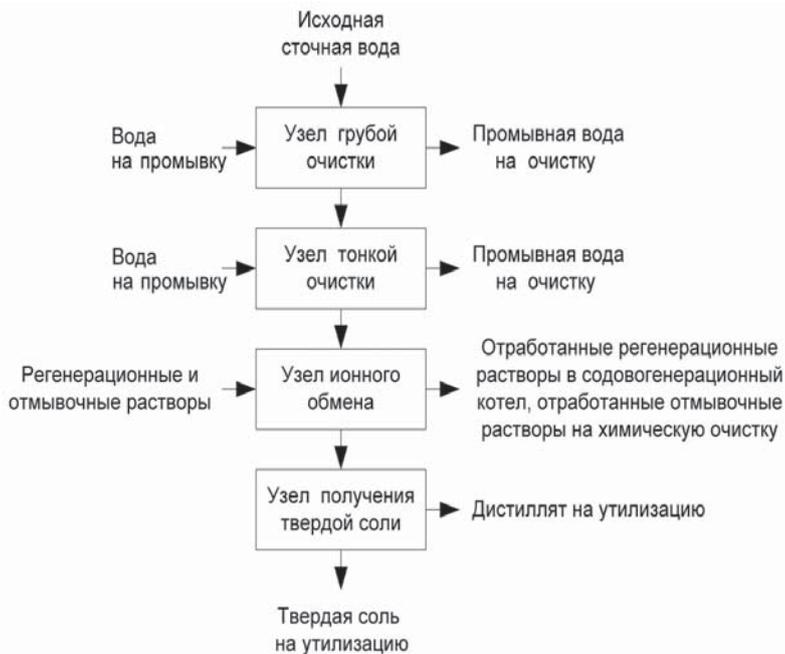
**Рис. 3.** Принципиальная схема очистки сточных вод на основе ионного обмена.
