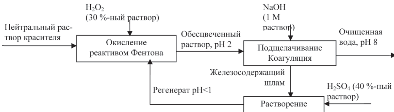
Рис. 3. Организация процесса регенерации железосодержащих шламов.
