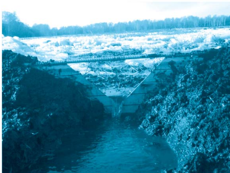
Рис. 2. Измерение расходов воды водосливом Томсона на стерне многолетних трав.
