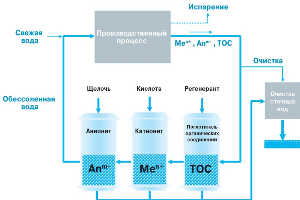
Рис. 4. Схема процесса рециркуляции воды.
