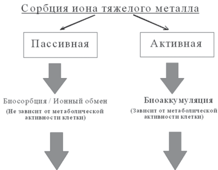
Рис. 1. Схема осуществления сорбции ионов тяжелых металлов дрожжами.
