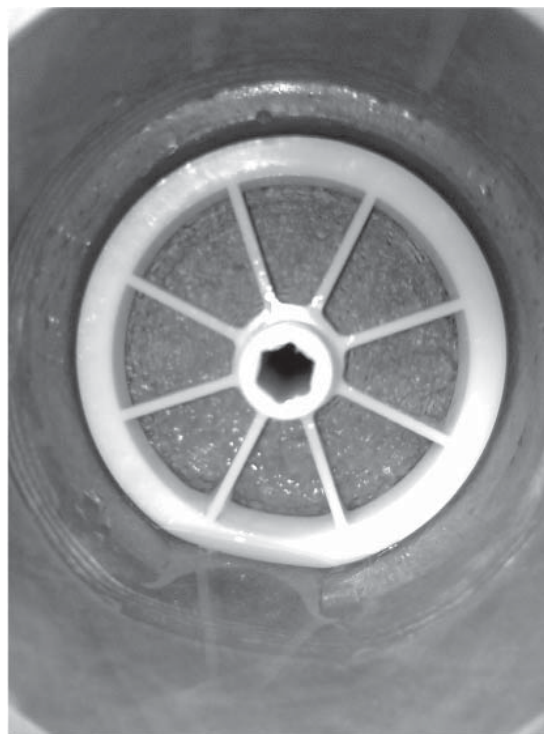
Рис. 6. Отложение осадка на торце обратноосмотического фильтроэлемента.
