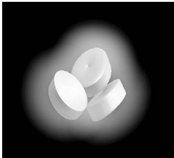
Рис. 4. Люминесцирующие гранулы с иммобилизованными в криогеле ПВС бактериями Ph. phosphoreum шт. 331 ККМ МГУ
