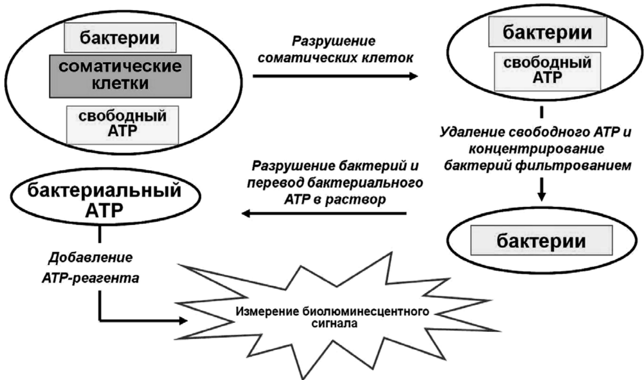
Рис. 3. Схема биолюминесцентного определения внутриклеточного АТР в биологическом образце
