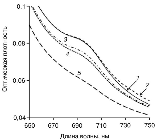
**Рис. 2.** Изменение конформации цитохрома *c* под действием метанола. Концентрация метанола в водном растворе цитохрома *c*: 1 – 0, 2 – 10, 3 – 20, 4 – 30, 5 – 40% (по объему). Исчезновение максимума поглощения при 695 нм говорит о разрыве координационной связи  $>\text{Fe}^{3+}\dots \text{S}(\text{Met}80)$  в результате частичного разворачивания молекулы белка
