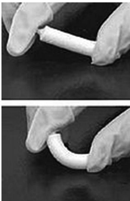
Рис. 2. Гибкий гидрогель-гидроксиапатитный композит, который имеет соотношение органической и минеральной частей, приближенное к таковому у человеческой кости.
