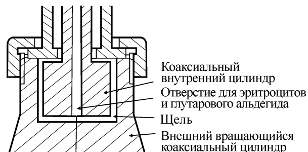
Рис. 1. Схема устройства для деформации эритроцитов в сдвиговом потоке.
