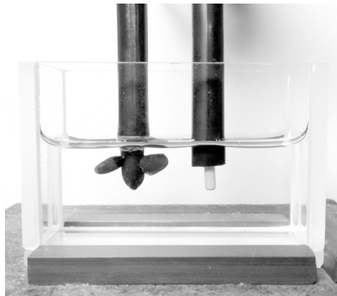
Рис. 3. Датчик температуры (справа) и трехлопастная пластиковая мешалка (слева) в одной из кювет.
