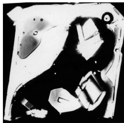
Рис. 4. Монокристаллы \text{FeSO}_4 \cdot 4\text{H}_2\text{O} в «луже» кристаллизационной воды (черный цвет в поляризованном свете), выделяющейся в процессе дегидратации в монокристалле \text{FeSO}_4 \cdot 7\text{H}_2\text{O} , \times 80 .
