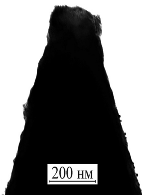
Рис. 2. Зонд АСМ, на острие которого подготовлена площадка для «пришивки» крупной (осповакцина) вирусной частицы. Просвечивающая электронная микроскопия.
