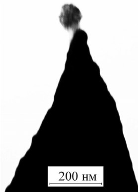
Рис. 4. Фрагмент бактериофага AP22 на острие зонда АСМ. Просвечивающая электронная микроскопия.
