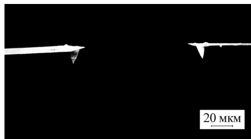
Рис. 1. Ячейка для диэлектрофореза с зондами АСМ в качестве электродов. Сканирующая электронная микроскопия.
