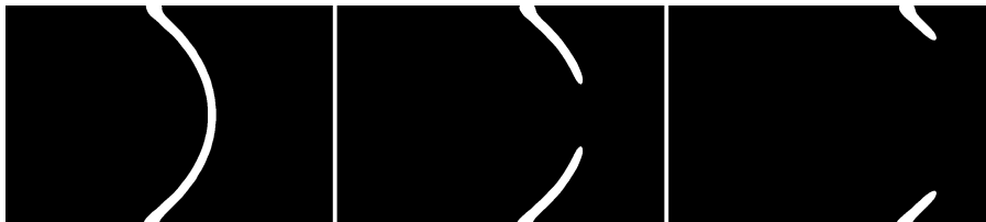
Рис. 7. Разрыв фронта при движении волны по направлению пуазейлева потока.
