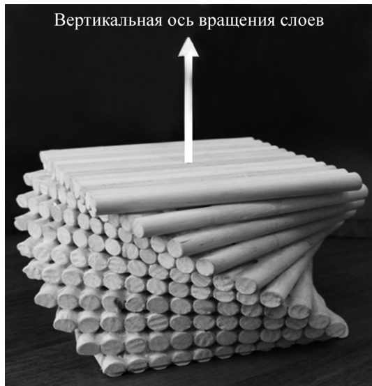
Рис. 2. Вид модельной, слоевой, спирально закрученной структуры из склеенных между собой деревянных палочек. Слой образуют 10 палочек. Каждый последующий слой повернут вправо по отношению к предыдущему на 9^\circ , в результате чего 10-й слой оказывается повернутым относительно 1-го на 90^\circ . Условно выделена вертикальная ось вращения слоев.
