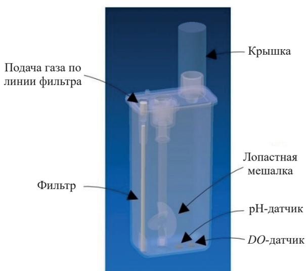
Рис. 2. Схема минибиореактора ambr<sup>®</sup>15
