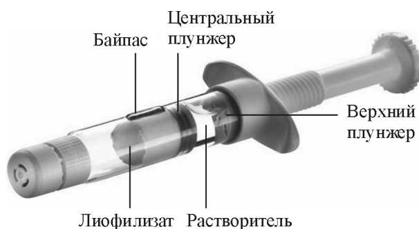
Рис. 1. Конструкция двухкамерного шприца
