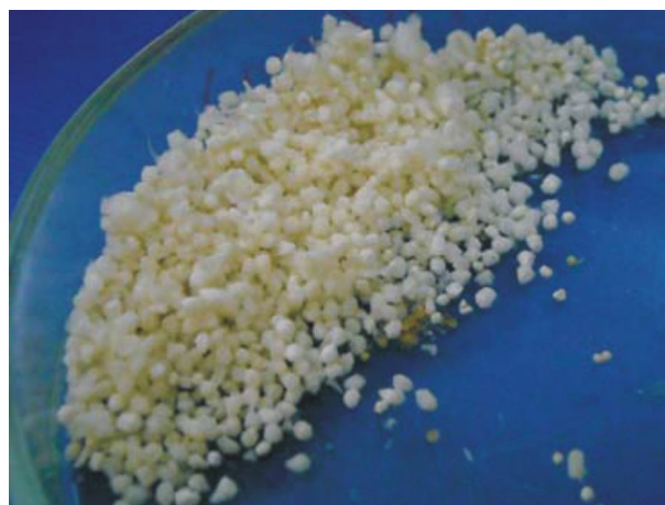
Рис. 2. Бусины на основе хитозана. Увеличение \times 1
