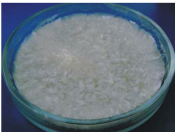
Рис. 1. Лиофилизованная пористая губка из хитозана. Увеличение \times 1
