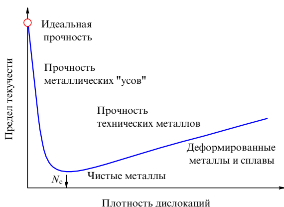
Рис. 2. Схематическое представление зависимости напряжения пластического течения кристаллического тела от плотности дислокаций [18].
