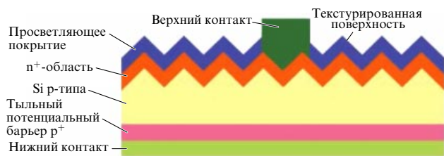
Рис. 3. Схематическое изображение СЭ на основе кремния. Современный вариант конструкции с тыльным барьером [31].
