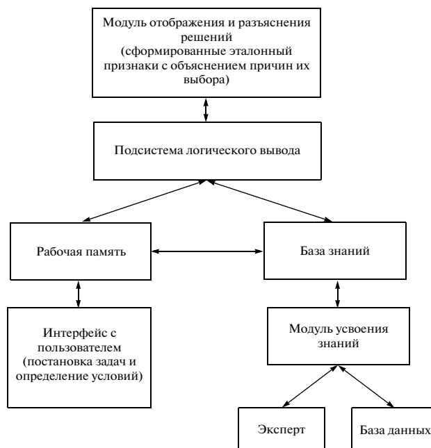
Рис. 1. Структура экспертной системы для определения эталонных признаков.
